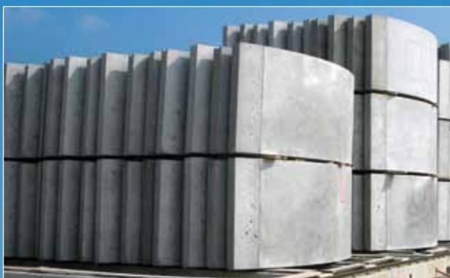
Παραγωγή προκατασκευασμένων στοιχείων, τελική επένδυση σήραγγας Weinberg, Ελβετία
