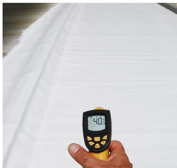
Θερμοκρασία δώματος μετά την εφαρμογή υγρής μεμβράνης
