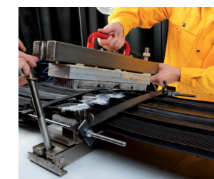
Πασπάλισμα της υδροφραγής με ταλκ και τοποθέτησή της μέσα στον εξοπλισμό βουλκανισμού
