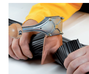
Εργαλείο συγκόλλησης με λάμα σε μορφή τσεκουριού
