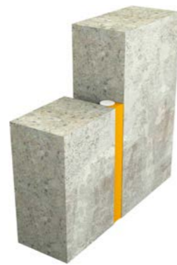
Κορδόνι υποστήριξης πολυαιθυλενίου και πυράντοχο σφραγιστικό αρμών
