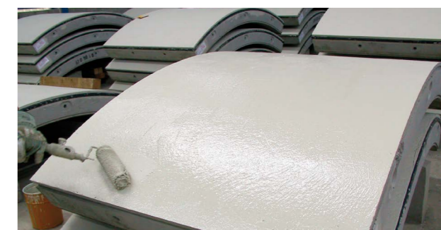
Αμέσως μετά την ωρίμανση σε θάλαμο με ατμό, τα προκατασκευασμένα στοιχεία επένδυσης σπράγγων βάφονται με εποξειδική βαφή υδατικής βάσης, η οποία απορροφάται ακόμη και στον μικρότερο πόρο, διαμορφώνοντας μία σφραγιστική, προστατευτική επίστρωση.
