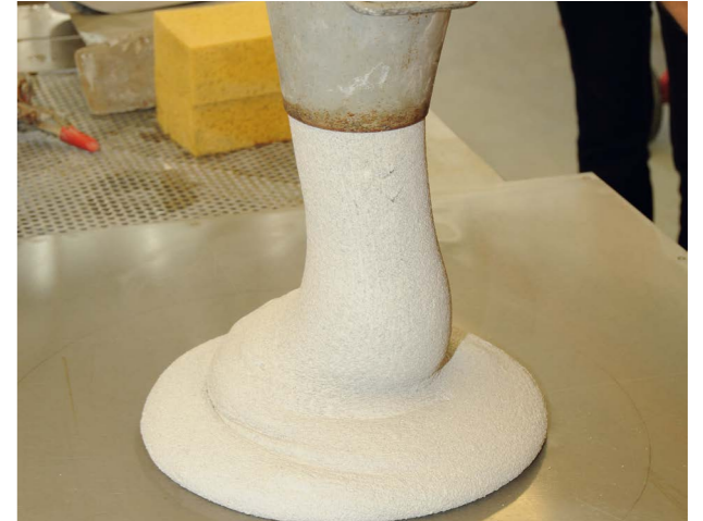
Σε περιπτώσεις θλιπτικής αντοχής πάνω από 150 Μpa δεν αναφερόμαστε πλέον σε συμβατικό σκυρόδεμα. Τα κλασικά αδρανή για παράδειγμα έχουν αντικατασταθεί από λεπτά αδρανή κεραμικής προέλευσης και ολόκληρη η μήτρα του συνδετικού υλικού μόνο αμυδρά θυμίζει το κλασικό σκυρόδεμα. Στην εικόνα φαίνεται η ρεολογική συμπεριφορά ενός σκυροδέματος υψηλής επιτελεστικότητας αντοχής της τάξης των 200 ΜPa.
