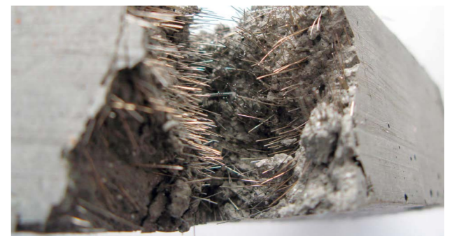
Το υψηλής αντοχής και πάνω απ' όλα το υπερυψηλής αντοχής σκυρόδεμα είναι πρακτικά πάντα ενισχυμένο με ίνες (ινοπλισμένο). Ανάλογα με τις απαιτήσεις, χρησιμοποιούνται συνθετικές και/ή μεταλλικές ίνες σε μεγάλη ποσότητα. Με αυτόν τον τρόπο μπορεί να επιτευχθεί υψηλή καμπτική αντοχή του σκυροδέματος υψηλής επιτελεστικότητας. Κεντρικές σημασίες για την επίτευξη υψηλών μηχανικών ιδιοτήτων του υλικού είναι ο στοχοθετημένος προσδιορισμός της έννοιας των λεπτών υλικών και του όγκου της πάστας τσιμέντου. Μόνο με αυτόν τον τρόπο μπορεί να επιτευχθεί η υψηλότερη δυνατή πυκνότητα της μάζας του σκυροδέματος.
