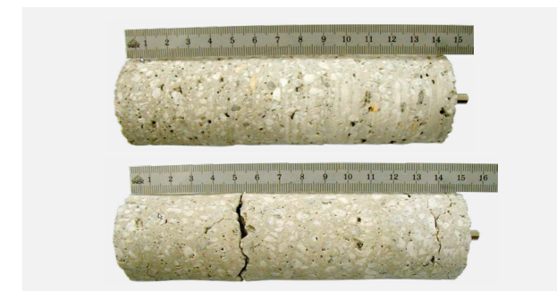
Η υποβάθμιση του σκυροδέματος λόγω της προσβολής από θειικά άλατα πριν και μετά την επαφή του με αυτά απεικονίζεται μέσω αύξησης του μήκους του πυρήνα σκυροδέματος, εξαιτίας της επίθεσης. Οι πρώτες ρωγμές είναι εμφανείς στο δοκίμιο.
