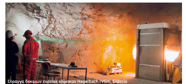
Σε ειδικούς θαλάμους κλιβάνων μπορούν να αναπαρασταθούν οι τροχιές φωτιάς, να καταπονηθούν πάνελα και στη συνέχεια να λάβει χώρα αξιολόγηση. Η ανάπτυξη της θερμοκρασίας μετράται σε διάφορα βάθη και καταγράφεται.
