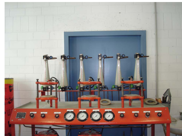
Η μέθοδος της διείσδυσης νερού υπό πίεση υπολογίζει το μέγιστο βάθος διείσδυσης νερού σε mm μετά από καθορισμένο χρονικό διάστημα και συγκεκριμένη πίεση (72 ώρες, πίεση 5 bar σύμφωνα με EN12390-8).
