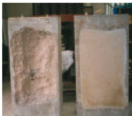
Σύγκριση σε δοκιμή φωτιάς Απλού Σκυροδέματος και Σκυροδέματος που περιέχει με Sika® Fibermesh®-150F
