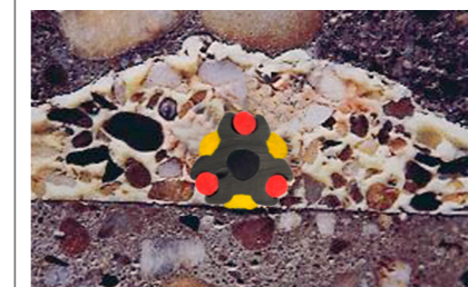
Οι λωρίδες νεοπρενίου (κόκκινες) συμπίεζονται υπό πίεση έγχυσης. Το υλικό έγχυσης μπορεί να διεισδύσει στον αρμό και τη δομή (Φάση 2)
