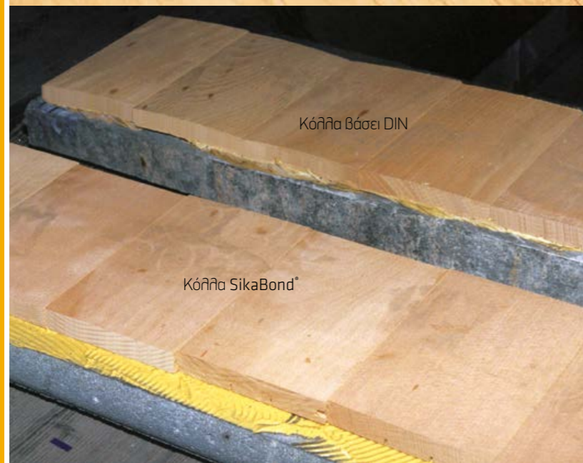
Σχ. 5: Δοκιμή κάτω από ακραίες συνθήκες: μιαίρ σανίδα από οξιά πάχους 21mm, 22% περιεχόμενη υγρασία
