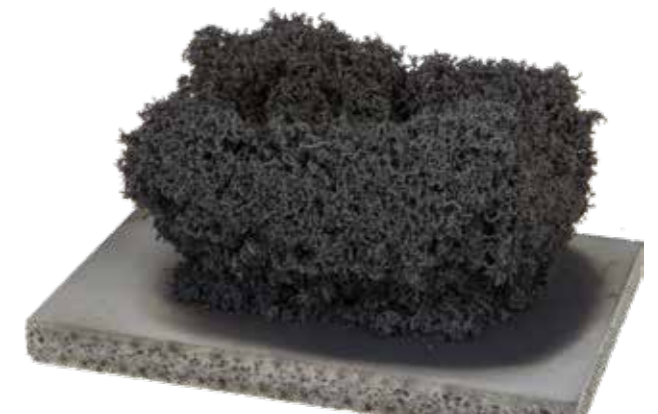
Υψηλής διόγκωσης, πυράντοχο πλέγμα πριν (αριστερά) και μετά (δεξιά) την έκθεση σε θερμότητα.
