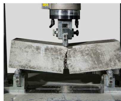
Δοκιμή κάμψης τριών σημείων: EN 14651
