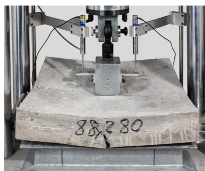
Δοκιμή τετράγωνου πανέλου: EN 14488-5
