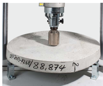
Δοκιμή στρογγυλού πανέλου: ASTM C1550
